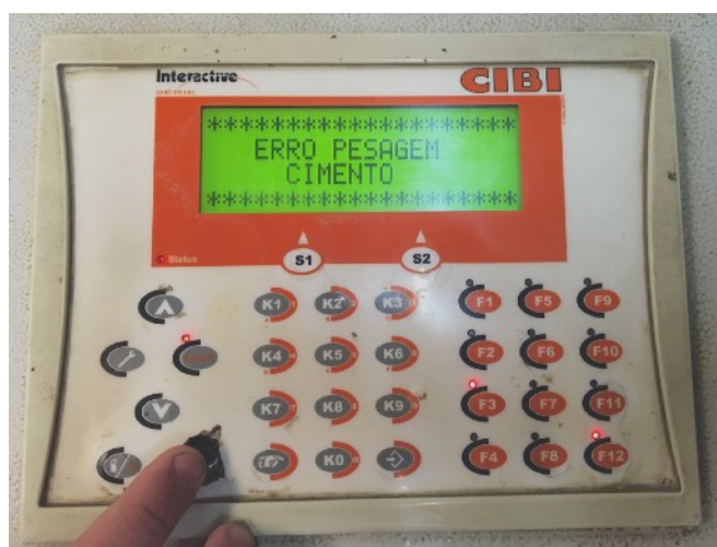
Interface de operação antiga com defeito em um dos botões.
